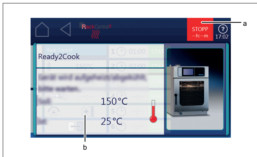
Figur: Vinduet Afslutning af RackControl2 før tid
